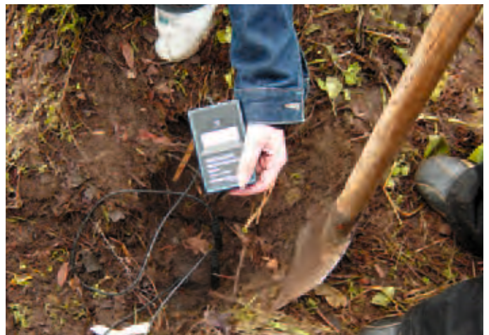
Temperaturmessung im Kompost
