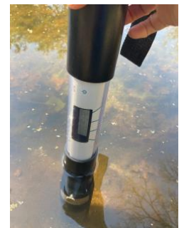
ABBILDUNG 4: CHLOROPHYLLMENGE MIT SONDE ALGAE TORCH MESSEN
